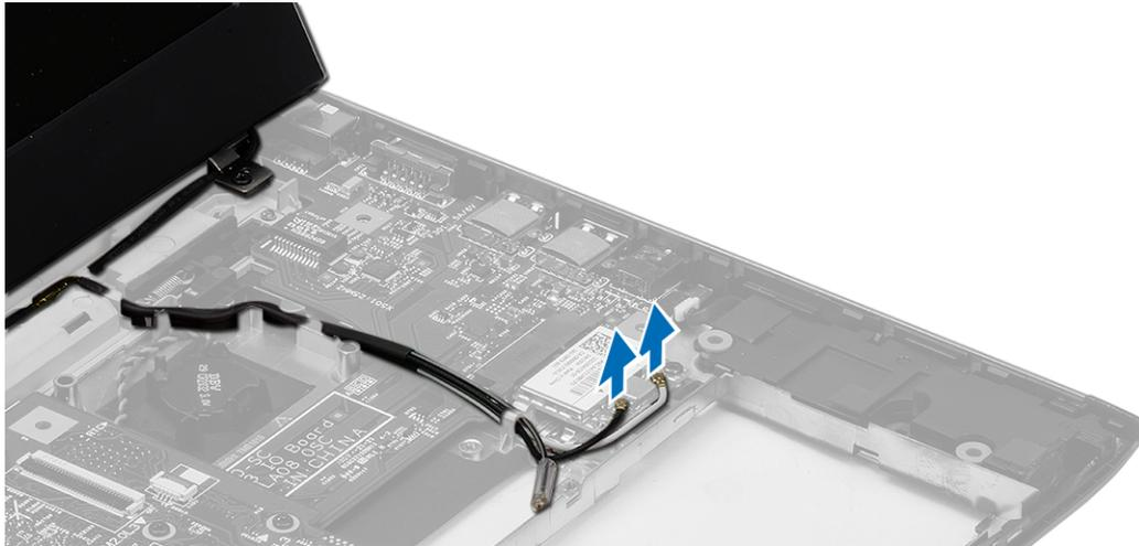
5. 將顯示器纜線從電腦拔下，然後將它從固定導軌鬆開。
